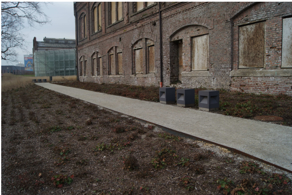
Zdjęcie nr 23. Widok na budynek nie objęty pracami renowacyjnymi (przy wjeździe głównym do budynku administracyjnego). Widoczne naniesienie żwiru ze ścieżki na obszar zieleni. Widoczna niemal całkowita degradacja roślin po obydwóch stronach ścieżki spowodowana ustawicznym zaleganiem wód opadowych.
