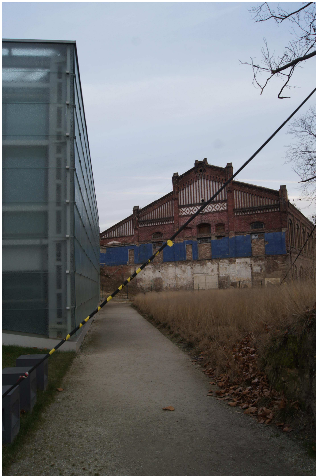
Zdjęcie nr 25. Widok na naroże budynku MS-CH od strony dojścia od szybów górniczych. Widok na budynek nie objęty pracami renowacyjnymi (ze zdjęć nr 23 i 24) od strony budynku MS-CH. Widoczne omszenie ścieżki wzdłuż elewacji budynku spowodowane ustawicznymi zastojami wody deszczowej.
