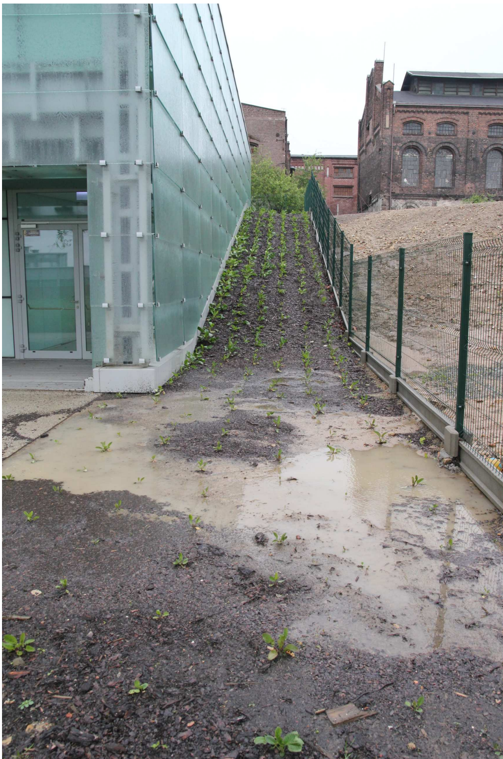
Zdjęcie nr 27a. Widok na naroże budynku MS-CH od strony dojścia od szybów górniczych. Widoczna degradacja roślinności spowodowana napływem wód opadowych z wyżej położonego terenu.
